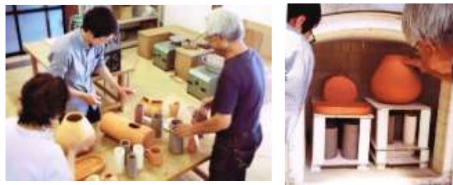
素焼きの窯出しの様子、この次に釉薬を付け本焼きです。
